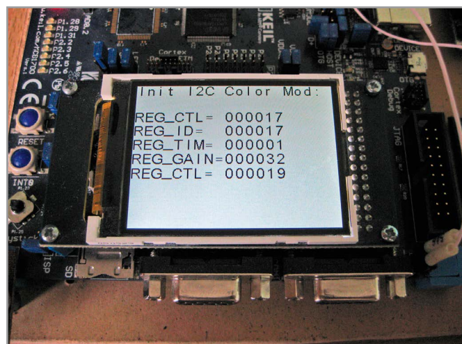
Рис. 8. Информация на ЖКИ, соответствующая успешной инициализации датчика I2C Color Sensor
