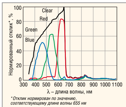
Рис. 2. Частотная характеристика датчика TCS3414CS
