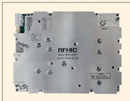
Данное устройство, построенное по схеме Догерти, имеет среднее значение выходной мощности 49 дБм в диапазоне частот от 1805 до 1880 МГц и рабочей полосы 75 МГц.
