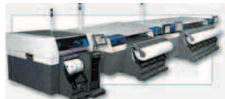
**Рис. 17. Высокопроизводительные автоматы для сборки компонентов поверхностного монтажа**
