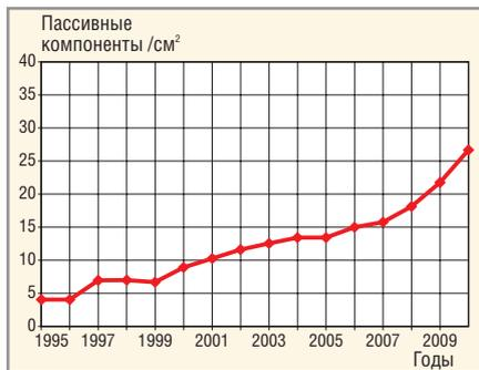
**Рис. 13. Увеличение плотности компонентов поверхностного монтажа в сотовых телефонах**
