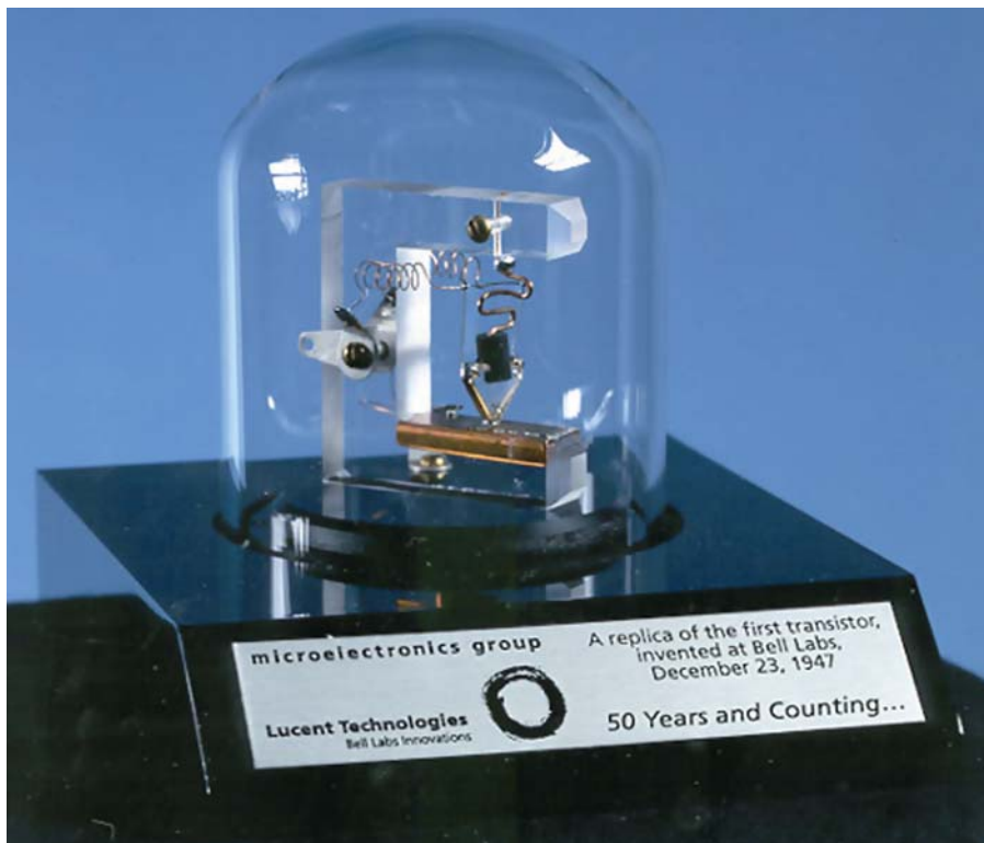
Рис. 1. Модель первого транзистора
