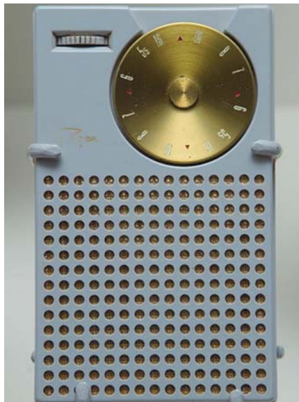
Рис. 3. Первый транзисторный приёмник
