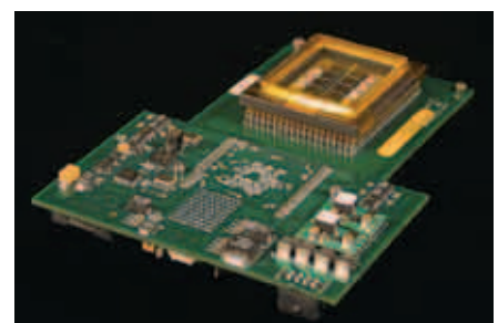
Рис. 6. Модуль MEMS-модулятора со схемой управления
