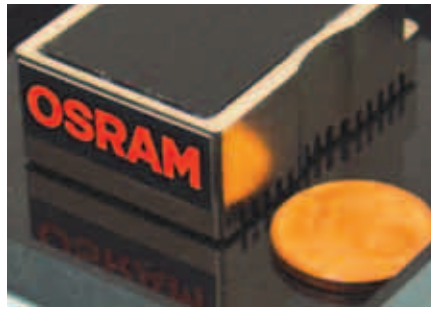
Рис. 12. Прототип лазерного модуля OSRAM для проекторов с механической развёрткой изображения
