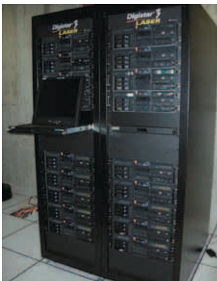
Рис. 7. Стойка с 16 процессорными блоками для управления проектором
