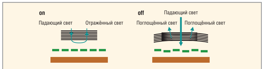
Рис. 2. Принцип работы решетчатого светового модулятора (GLM)
