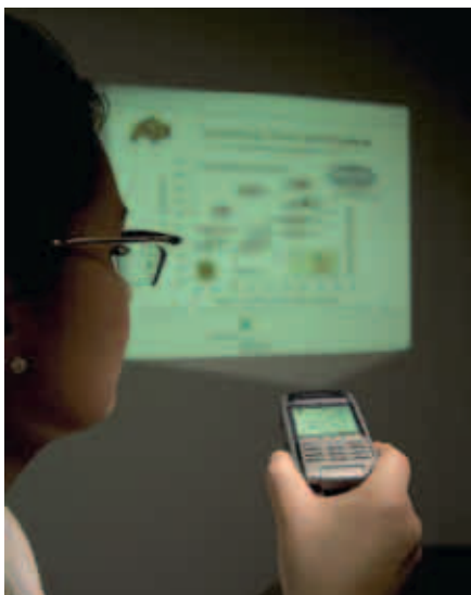
Рис. 17. Испытание прототипа встроенного в мобильное устройство проектора со стабилизацией изображения
